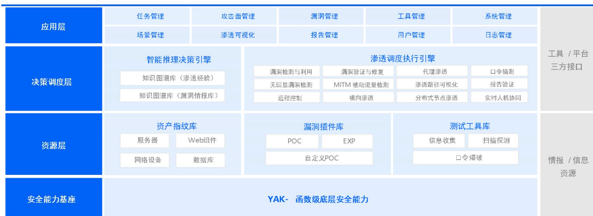
图 2：小智-智能渗透测试机器人架构图
